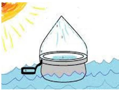
Hình 3. 12. Minh họa cách tạo nước ngọt từ nước biển bằng năng lượng Mặt trời
